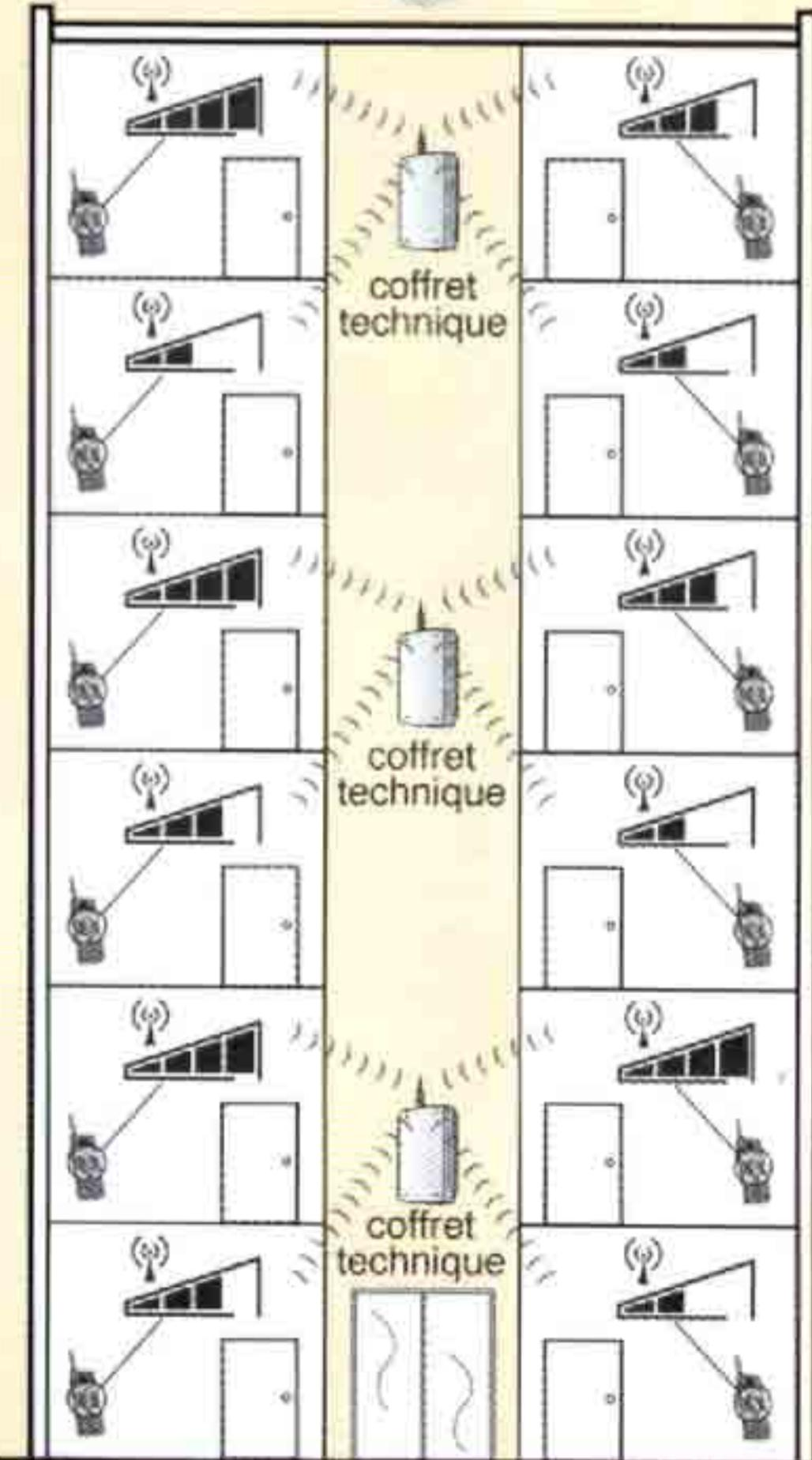
Avec 3 coffrets techniques, l'indicateur de réception radio confirme un niveau de réception radio correct pour chaque appartement (donc 3 coffrets radio sont nécessaires)
