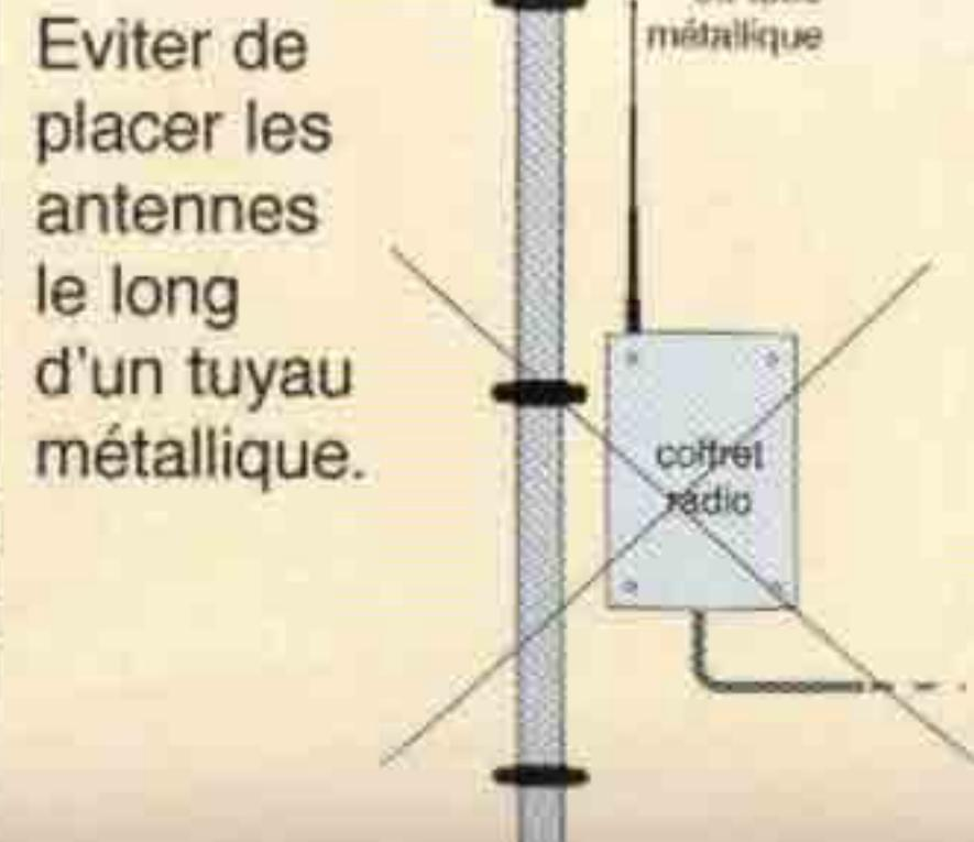
Eviter de placer les antennes le long d'un tuyau métallique.
