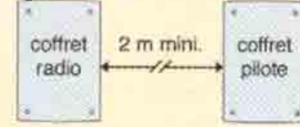
Respecter une distance minimum de 2 m entre le coffret radio et le coffret pilote.
