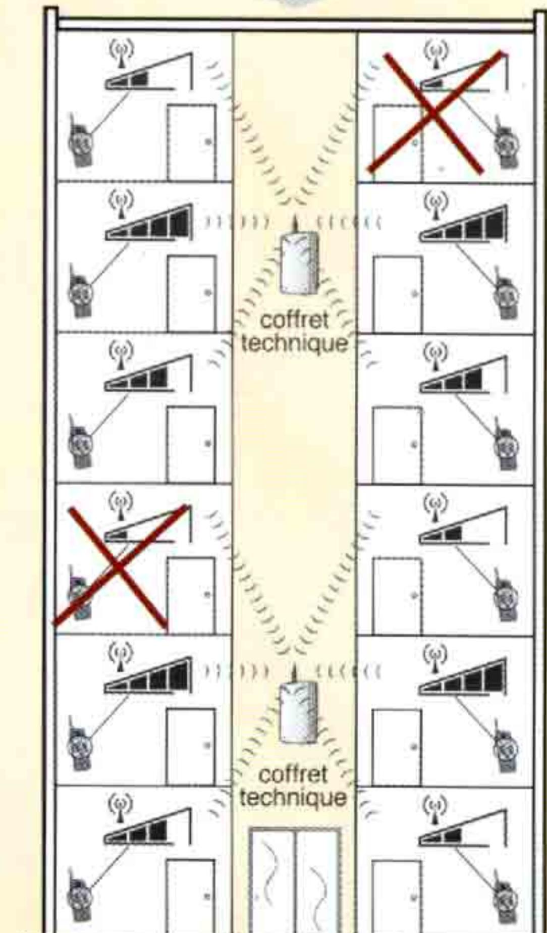
Avec 2 coffrets techniques, l'indicateur de réception radio confirme un niveau de réception radio insuffisant pour 2 des appartements (donc 2 coffrets radio sont insuffisants)
